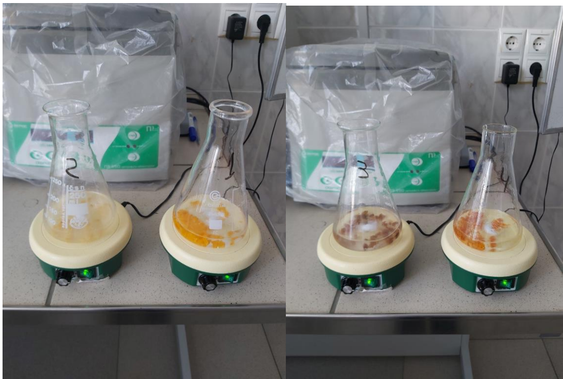
Рисунок В.5 – Подготовка пробы. Перемешивание с использованием магнитной мешалки
