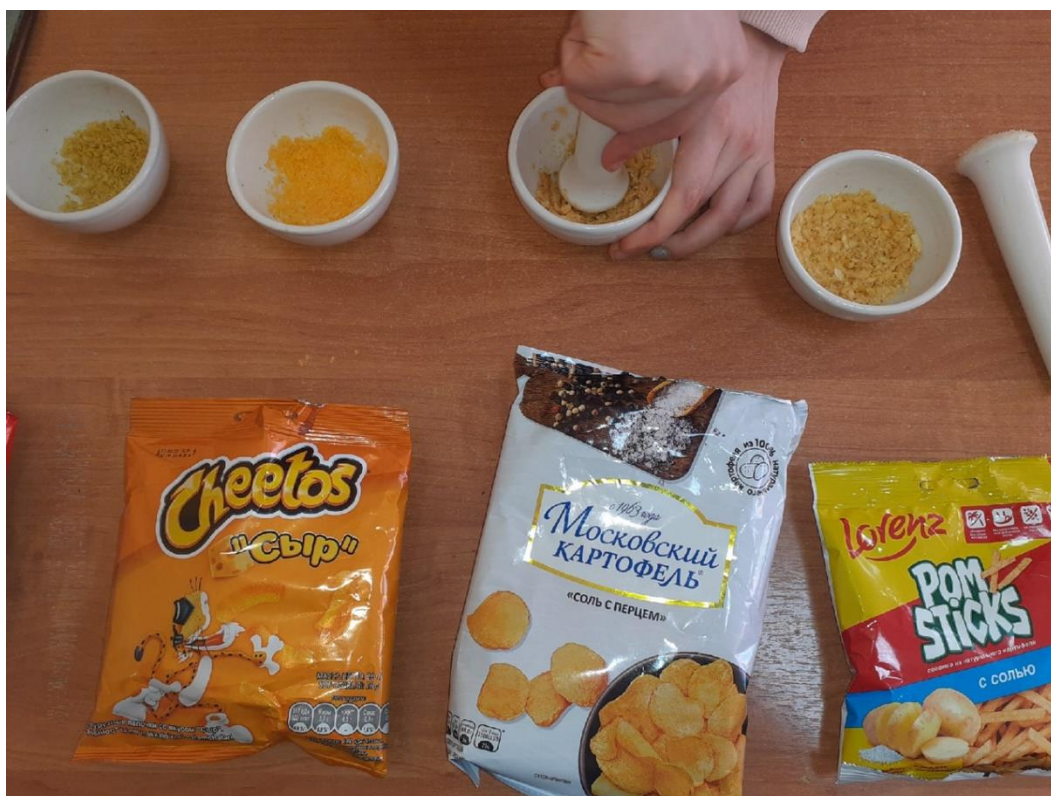
Рис.4- Приготовление водной вытяжки исследуемых образцов чипсов Раскрошить 1-3 чипса (1 г) и перенесите крошки в пробирку. Добавить 15-20 мл дистиллированной воды и нагреть пробирку в пламени спиртовки.
