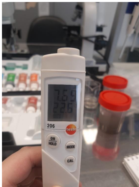
Фото 15-17 – Определение уровня pH снеговой воды при помощи pH-метра
