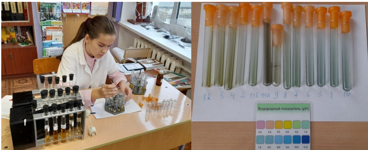
Рис. 8-9. Определение актуальной кислотности / щелочности ( pH_{вод} ) почв
