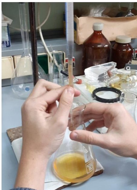
Рис.5. Определение щелочности почвенных вытяжек
