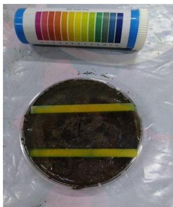
Рис.6. Определение уреазной активности экспресс-методом
