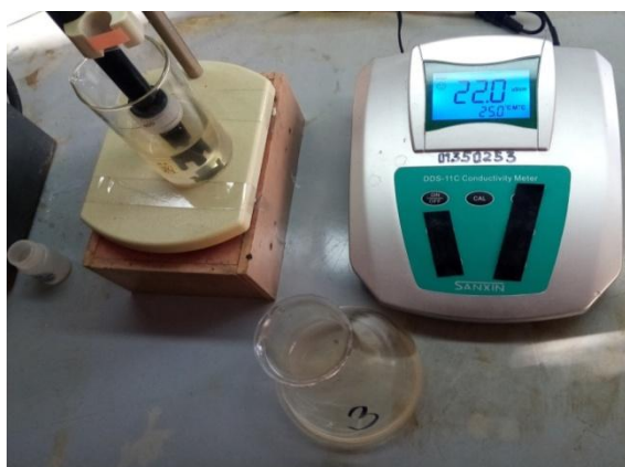
Рис.4. Определение электропроводности почвенных вытяжек
