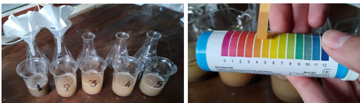
Рис.3. Фильтрование и определение pH Значения кислотности почвенных вытяжек
