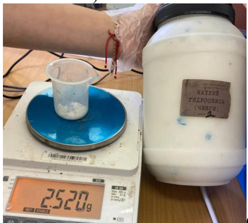
Рис. 6. Навеска NaOH ( а ) и \text{Na}_2\text{SiO}_3 \cdot 5\text{H}_2\text{O} ( б )
