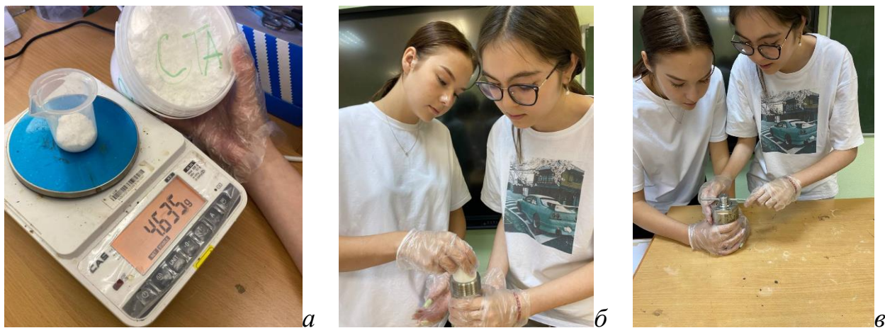
Рис. 7. Навеска СТА (а), перемещение смеси в капсулу автоклава (б) и его закручивание (в)
