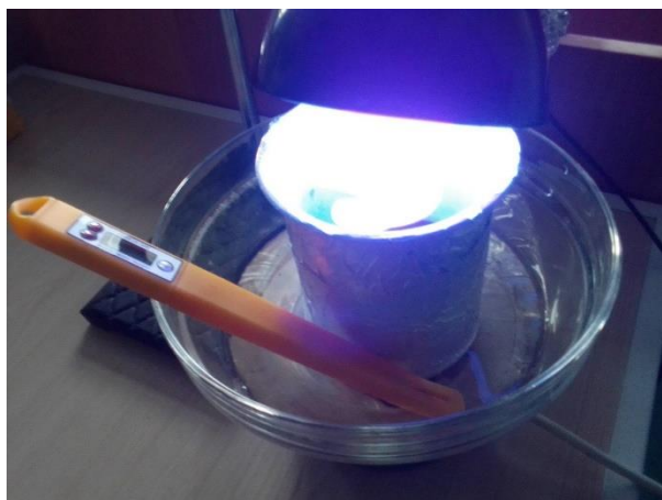
Рис. 18. Проведение фотокатализа (а) и вид ЭСП до и после центрифугирования пробы (б)
