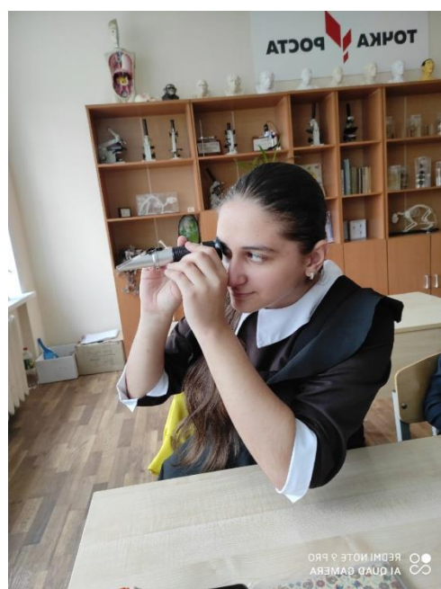
Замеры содержания сахара рефрактометром в яблочном соке разных торговых марок
