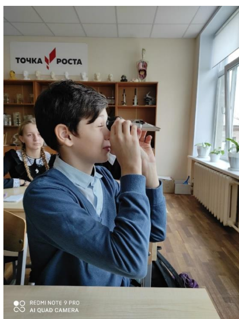
Замеры содержания сахара рефрактометром в яблочном соке разных торговых марок
