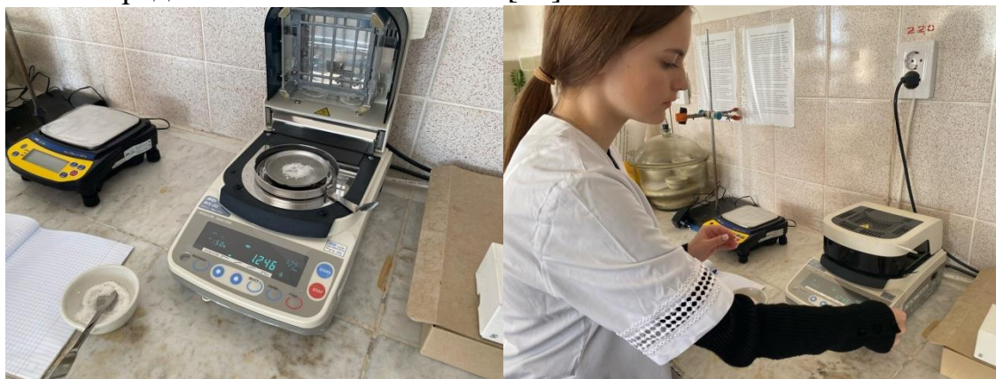
Рис 1.1.-1.2. Определение влажности соли
