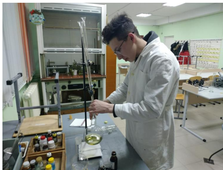
Рисунок 4. Определение ХПК в лаборатории МУДО «ВЭЦ».
