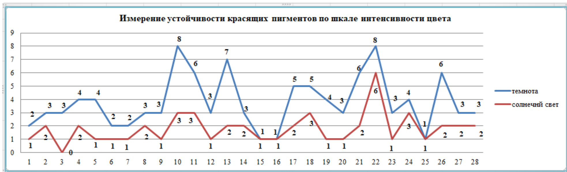
Рисунок 2.1 – Измерение устойчивости красящих пигментов по шкале интенсивности цвета
