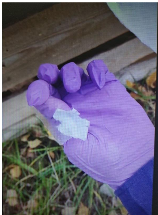
Рис. 6, 7 Показатель действенности состава, а именно не приклеивание скотча к нему
