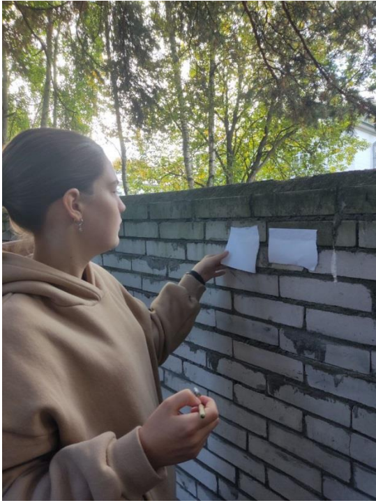
Рис. 9, 10,11 Поклейка бумаги на состав и место без него на бетон, дерево и железо в концентрации 1/3.
