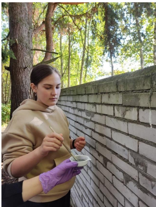
Рис. 3,4,5 Нанесение состава на железо, дерево и бетон в концентрации \frac{1}{4}
