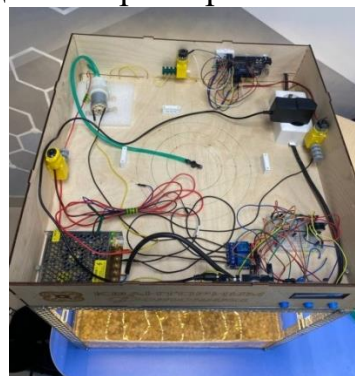
Рис.7 Реализация блока подъёма ярусов на разные уровни
