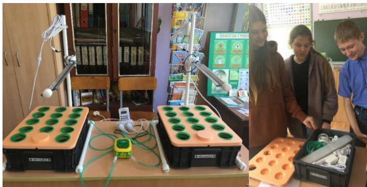
Рис.2-3. Сборка гидропонной установки
