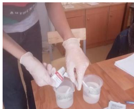
Рис. 5. Приготовление стандартов для калибровки рН-метра
