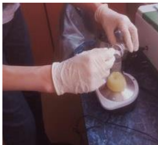
Рис. 6. Порция H_2O_2 (а; на врезке – смешение реагентов); перемешивание смеси на магнитной мешалке (б)
