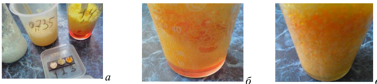
Рис. 23. Коллоидные системы с разными молярными концентрациями \text{TiOSO}_4 : а – продвижение фронта сшивки при c_0(\text{TiOSO}_4) = 0.21 моль/л через 4 минуты б – продвижение фронта сшивки при c_0(\text{TiOSO}_4) = 0.21 моль/л через 7 минут в – продвижение фронта сшивки при c_0(\text{TiOSO}_4) = 0.21 моль/л через 11 минут
