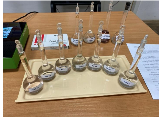
Рис.2 Мерные колбы с раб. ст. раствором доводят дистиллированной водой до 100 мл
