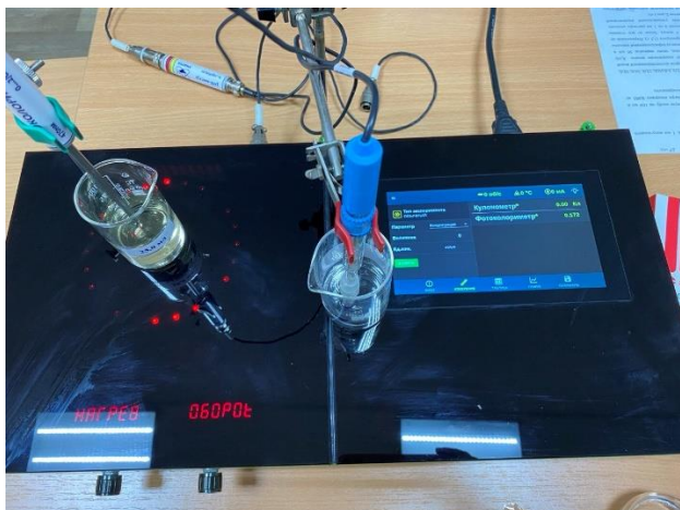
Рис.5 Показание оптической плотности на дисплее модуля «Экология»
