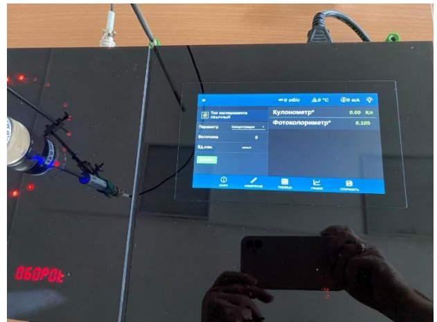
Рис.4 Показание оптической плотности на дисплее модуля «Экология»
