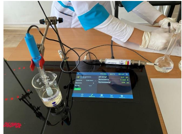
Рис.2 Показание рН на дисплее модуля «Экология»
