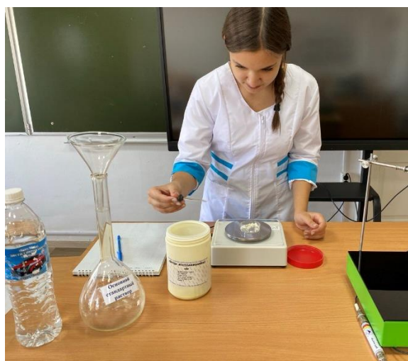
Рис.1 Приготовление основного стандартного раствора (железоаммонийных квасцов)
