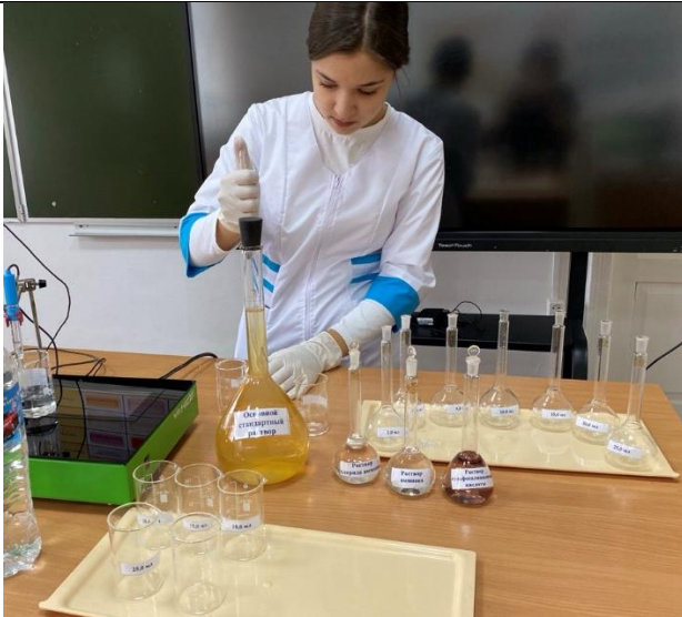
Рис.1 В мерные колбы добавляют 1,2,5,10,15,20, 25,30 мл рабочего ст. раствора
