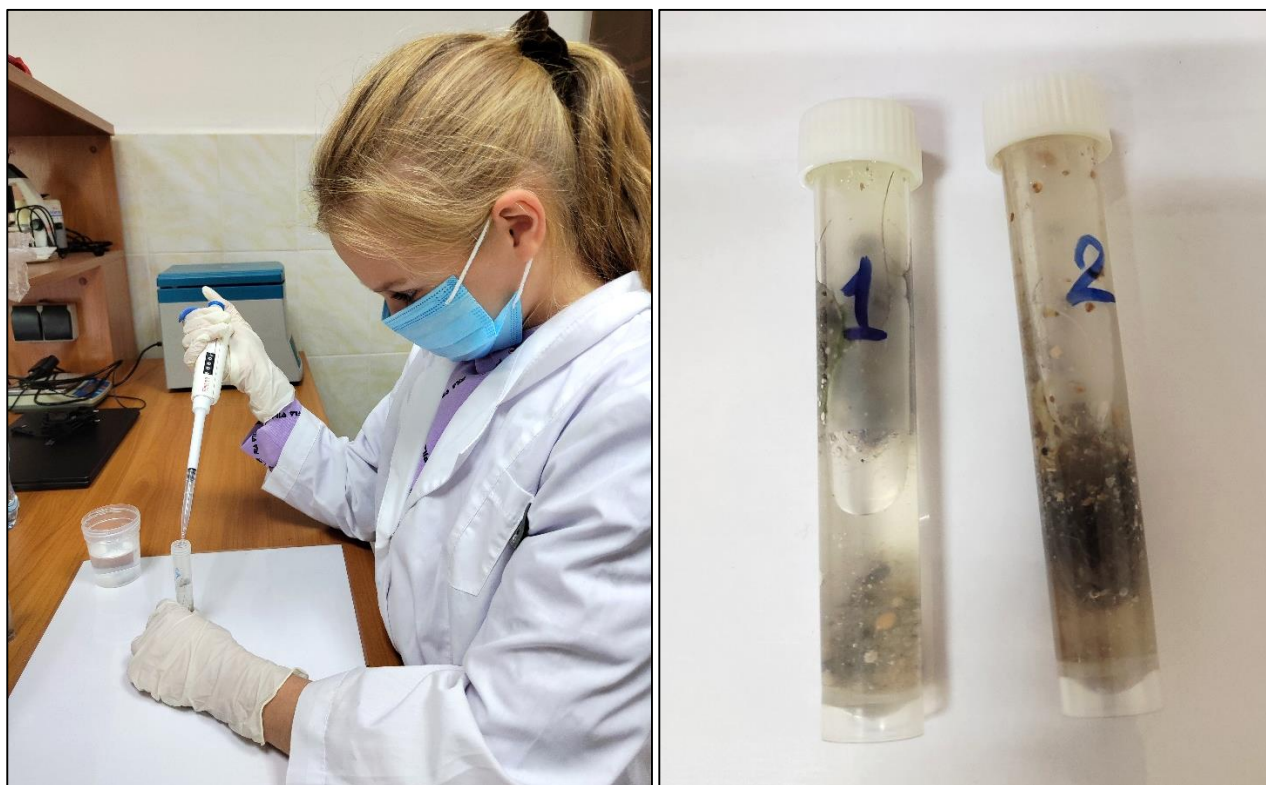
Рисунок 3. Подготовка образцов пыли к центрифугированию
