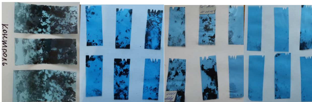
Рис.6. Образцы рентгеновской пленки после 3 суток экспозиции в контроле и почве пробных участков в весенний период
