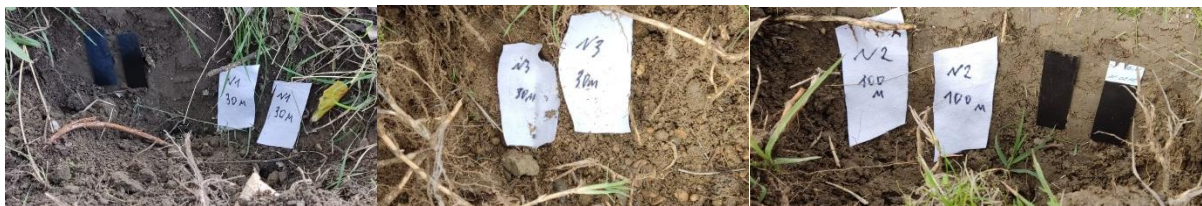
Рис.5. Закладка льняного полотна и рентгеновской пленки в почву
