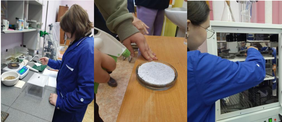
Рисунок 2 - Этапы проведения исследования (взвешивание, смачивание, помещение образцов в термостат)
