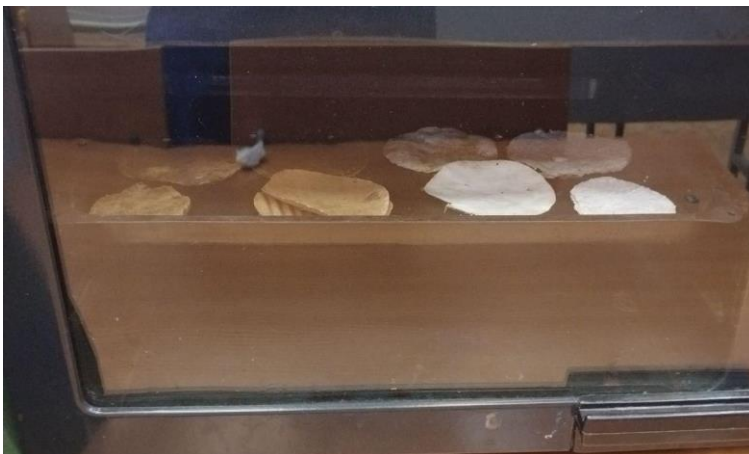
Рисунок 3 - Высушивание образцов в духовом шкафу
