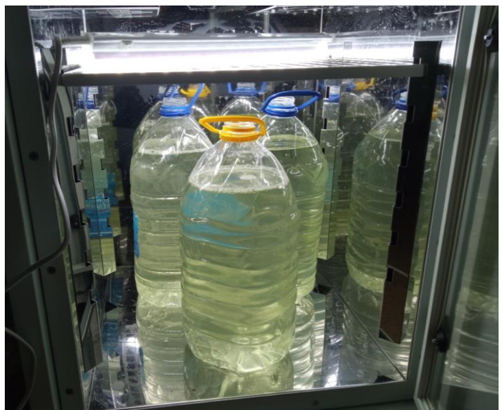
Рис.6 Выращивание водоросли хлорелла в термостате
