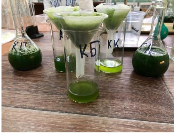
Рис.13 Фильтрация водной втяжки аскорбиновой кислоты
