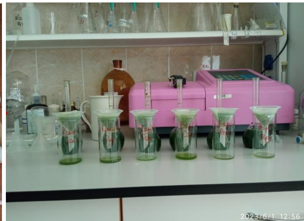
Рис.8 Фильтрация ацетоновой вытяжки пигментов
