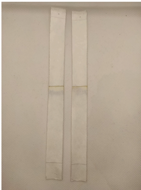
Рис. 8 – Хроматограммы растворов железа ( \text{Fe}^{3+} ) с концентрациями 1 мг/л и 0,01 мг/л (слева направо)
