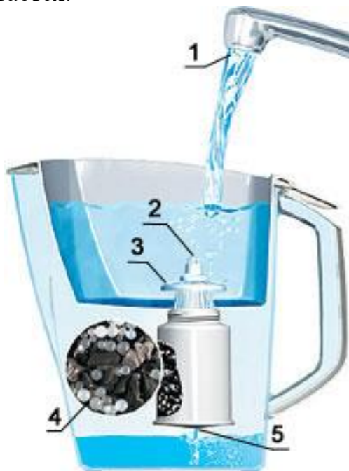
Рис. 1.1. Устройство фильтра-кувшин и принцип его действия 1 – неочищенная вода; 2 – верхняя часть фильтрующего картриджа; 3 – сеточка; 4 – адсорбент; 5 – очищенная вода
