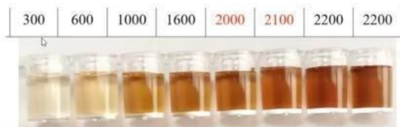
Рисунок 12. Шкала для оценки содержания углерода в почве, единицы измерения - количество мг углерода на кг почвы (мгС/кг почвы)
