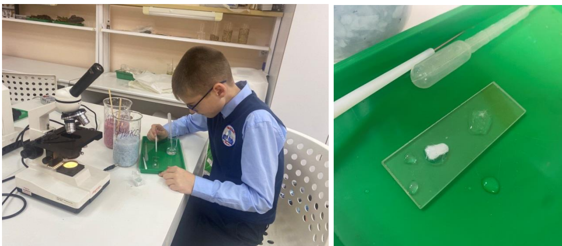
Рис.1-2. Изготовление препарата кусочка бумаги для микроскопического исследования
