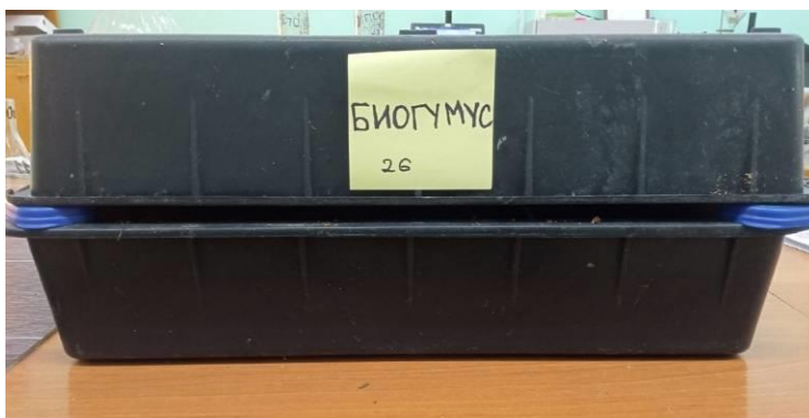
Рис.5 Вермиконтейнер (объем 5,0 дм 3 ) для получения биогумуса
