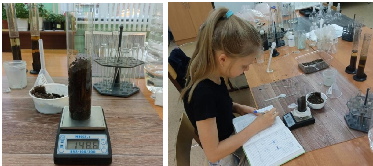
Рис.12 Определение влагоёмкости субстратов
