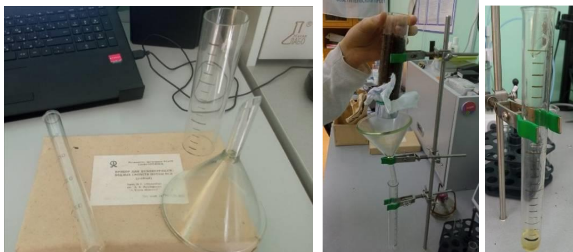
Рис.11 Определение водопроницаемости субстратов
