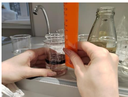
Измерение высоты слоя нефтепродуктов
