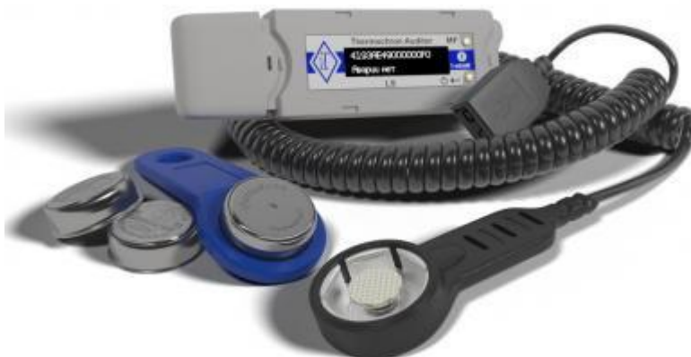
Рис. 4. Регистраторы температуры и влажности серии TR — TR-2V
