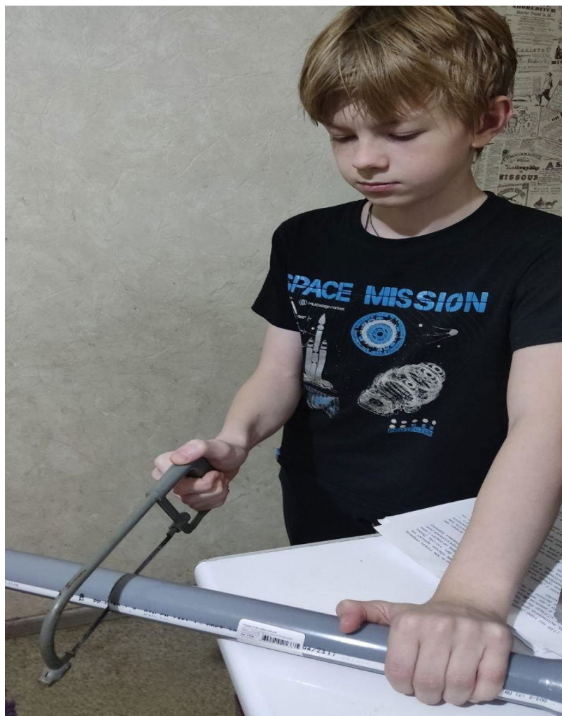
Приложение 2. Отпиливаю трубу нужного размера
