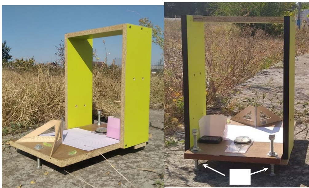
Рисунок 2.1.б. – Внешний вид установки, вид с торца и тыла, где 11 – регулировочные винты.
