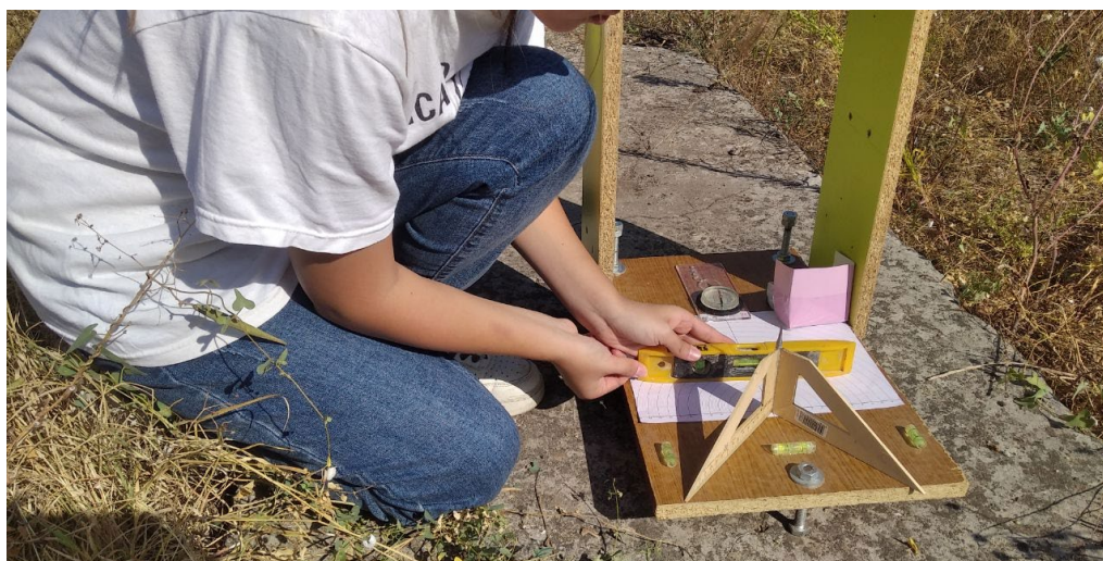
Рисунок 2.4. – Проверка горизонтальности установки.
