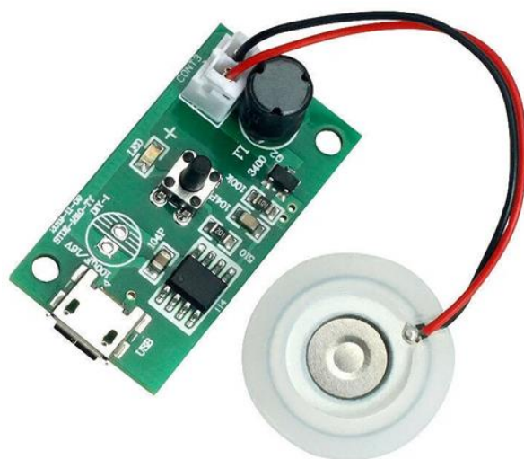
Рис. 5 Ультразвуковой преобразователь с драйвером датчики температуры и влажности, а также элементы питания и соединительные провода. Также стоит подготовить макетную плату для удобства соединения компонентов.
