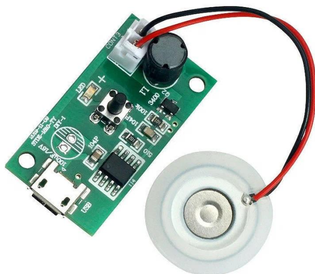
Рис.3 Драйвер (генератор) пьезо- керамической мембраны
