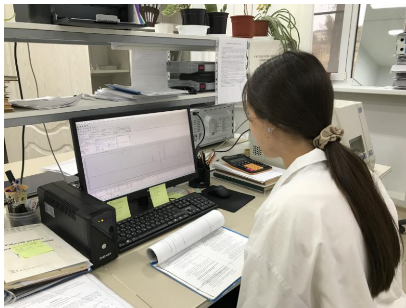
Фото 7 Определение содержания ионов в пробах воды с помощью аппарата капиллярного электрофореза «Капель 105М»
