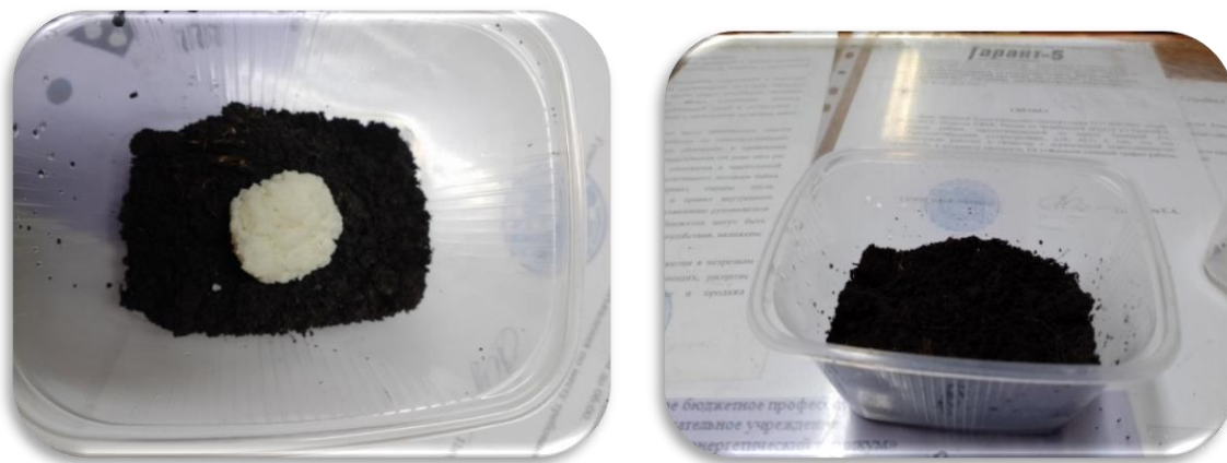
Рисунок 6 – Проверка разлагаемости пластика
