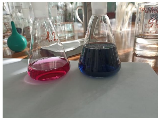
Рис. 15 Определение жесткости общей
