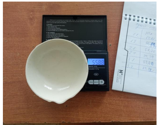
Рис. 14 Определение сухого остатка
