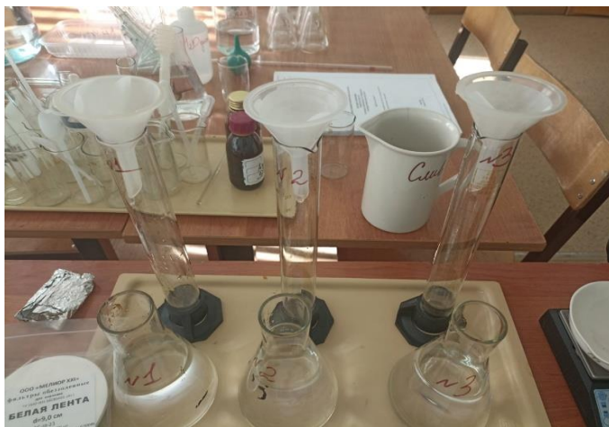
Рис. 14 Определение сухого остатка
