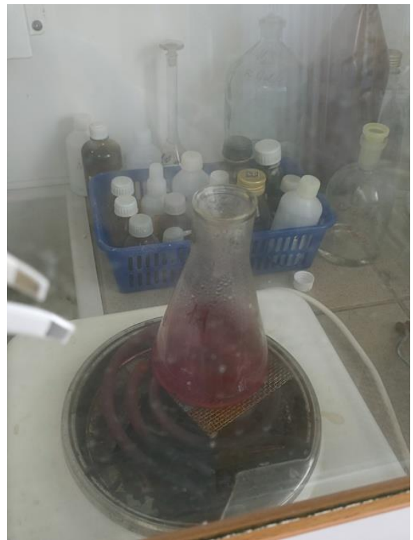
Рис. 16 Определение окисляемости перманганатной
