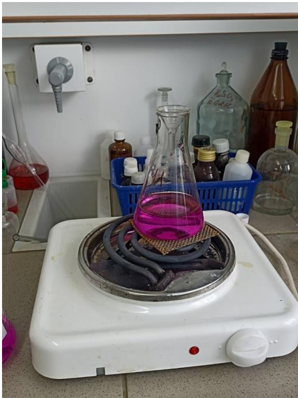
Рис. 16 Определение окисляемости перманганатной
