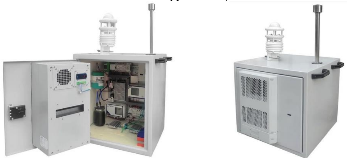
Рис. 1.2. Внешний вид и устройство стационарной системы контроля качества воздуха «АТМОСФЕРА» [6]
