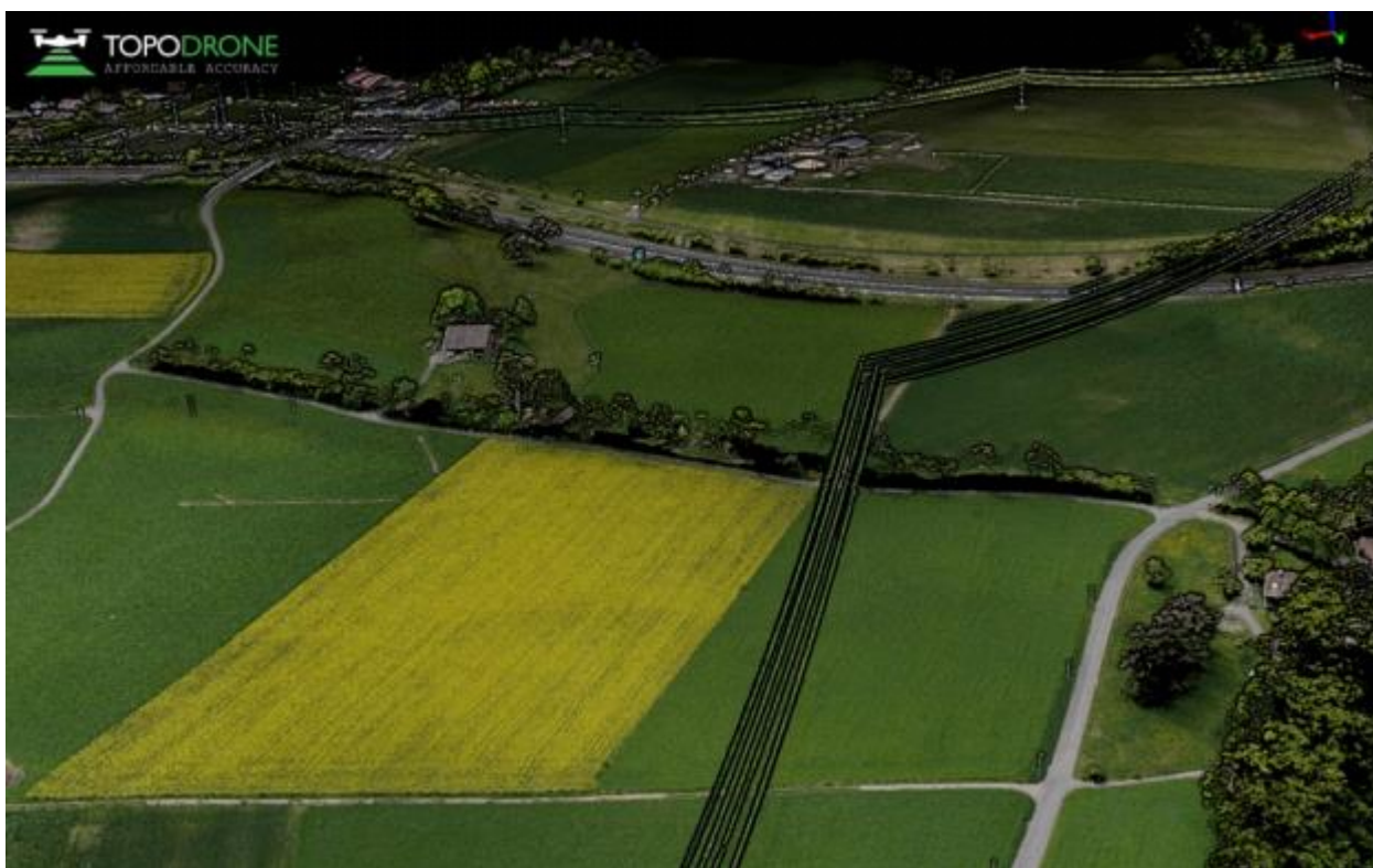
Высокодетальное облако точек с высоты съемки 120 метров, отображающее опоры ЛЭП и провисы проводов.
