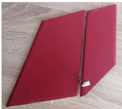
Элементы хвостового оперения после и во время обтяжки плёнкой
