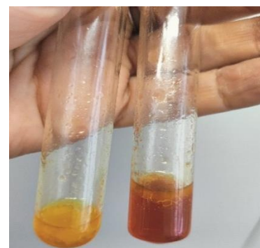
Рис.7 Изменение цвета масла после реакции с хлоридом железа;
