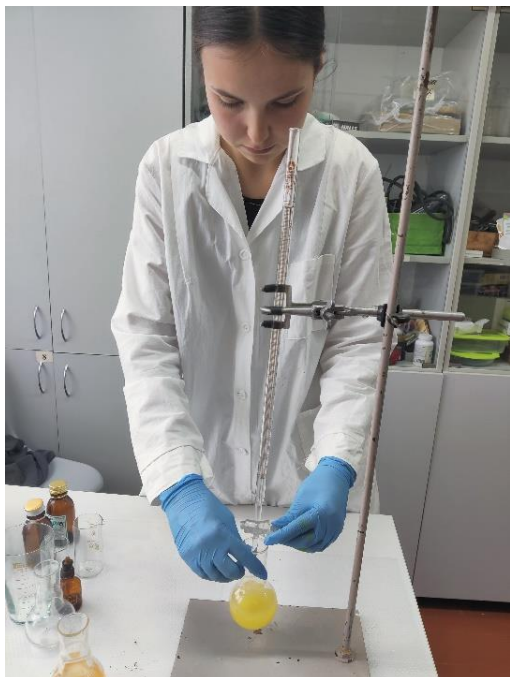
Рис. 4. Титриметрический метод определения кислотного числа масла
