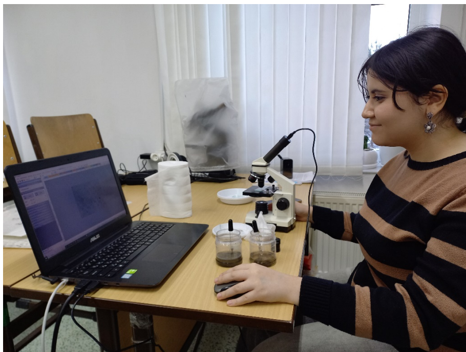
Рис.1 Микрофотографирование и съёмка активного ила
