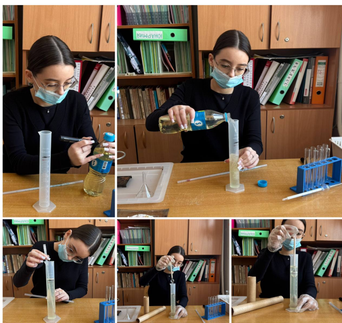
Рис 5. Определение плотности бензина.
