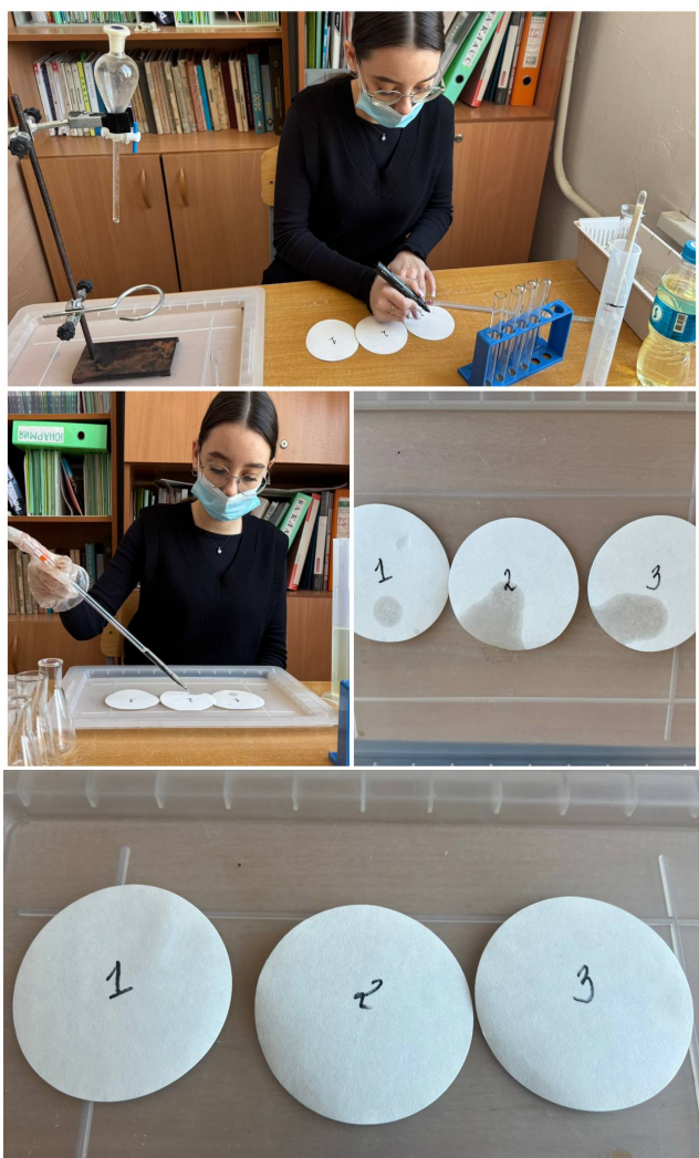
Рис 7. Определение посторонних добавок (жира).
