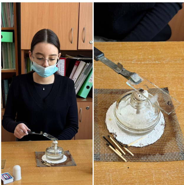
Рис 8. Определение посторонних добавок (смол, масел).
