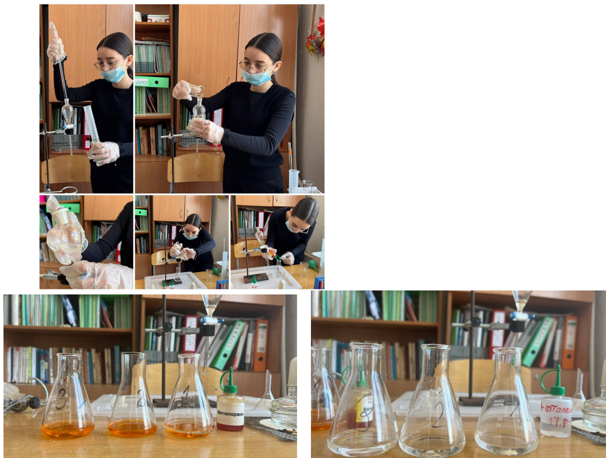
Рис 6. Определение наличия водорастворимых кислот и щелочей.
