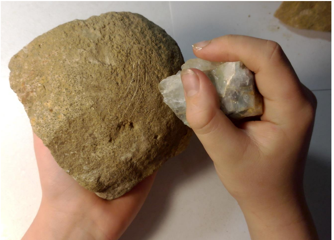
Приложение 7 – Определение относительной твёрдости образца конкреции (фото, сентябрь 2025 года)
