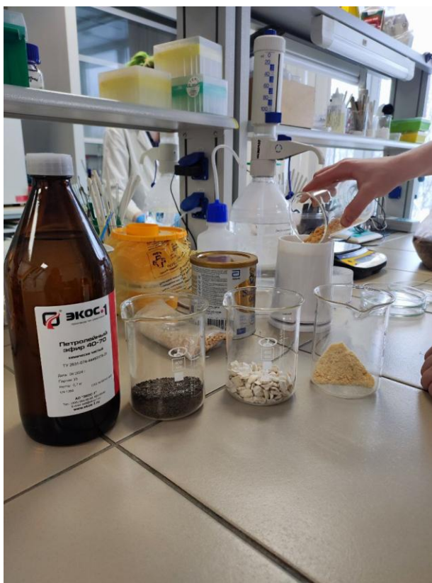
Рис. 2. Процесс обезжиривания образцов жмыха с помощью петролейного эфира (подсолнечник, арахис, горох)
