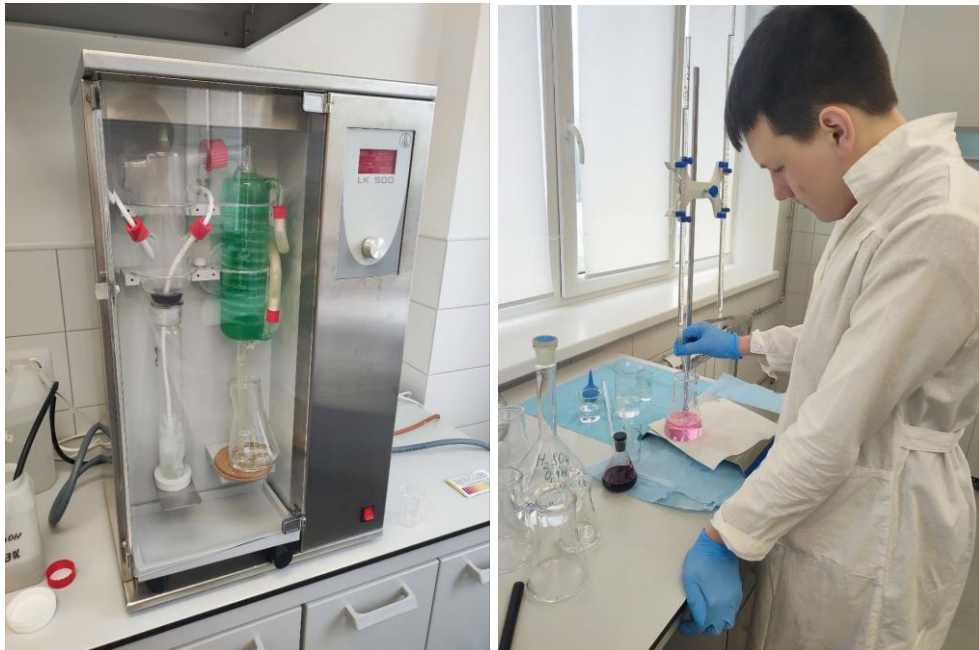
Рис.4. Процесс определения количественного содержания белка методом Кьельдаля.
