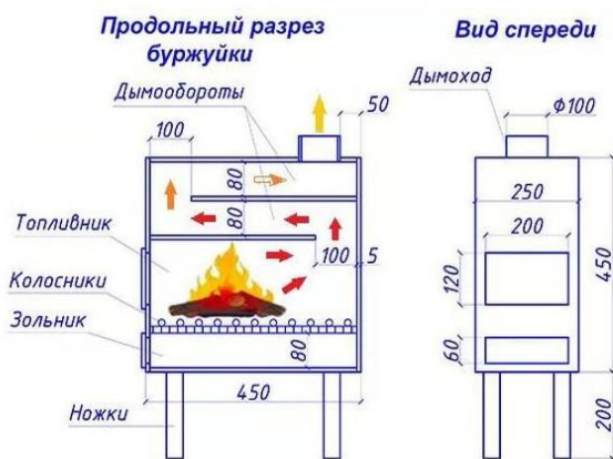
Схема 1. Печь в разрезе.
