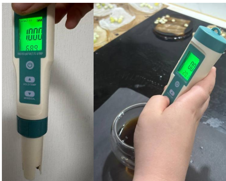
Рисунок 3. Определение кислотности среды напитков с помощью датчика
