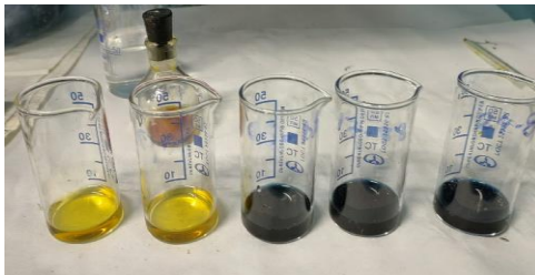
Рис.7 Процесс количественного ФЭК-определения ПВС в ВИС (а – фильтраты аэротенков до внесения йода, б – фильтраты аэротенков №1-4 после добавления йода)
