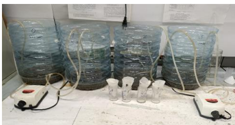
Рис. 1 Лабораторная установка для экспозиции ПВХ в водно-иловой смеси (модельные аэротенки)
