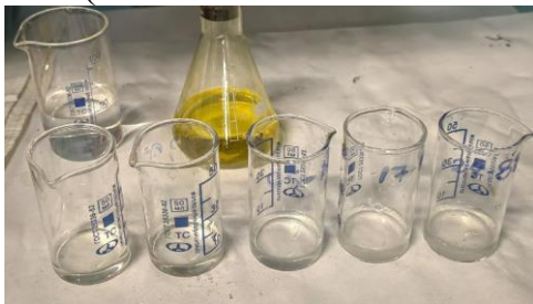
Рис.6 Пенообразование в ВИС, загрязненной ПВС, при взбалтывании (а – ВИС в состоянии покоя, б – ВИС после взбалтывания)
