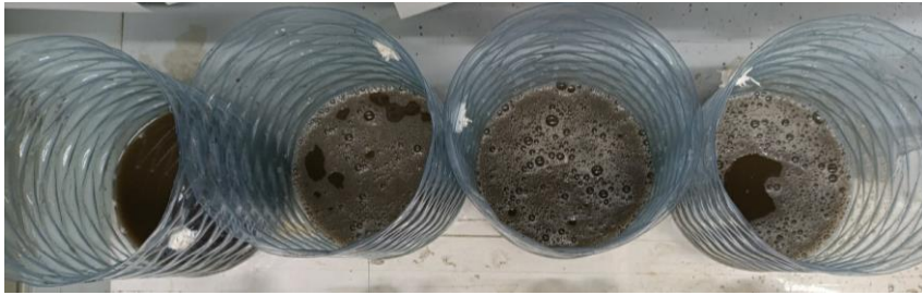
Рис.6 Пенообразование в ВИС, загрязненной ПВС, при взбалтывании (а – ВИС в состоянии покоя, б – ВИС после взбалтывания)
