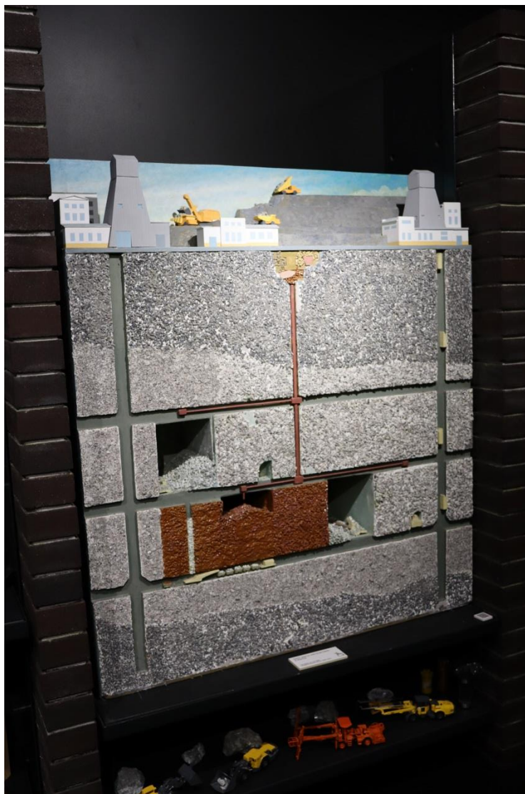
Рисунок 11 Модель залегания магнезита и способа его добычи подземным способом
