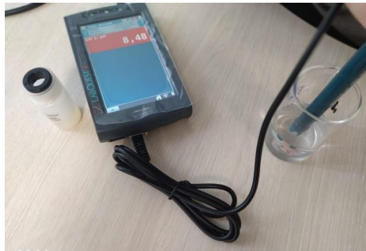
Рис. № 7 Измерение pH датчиком Vernier
