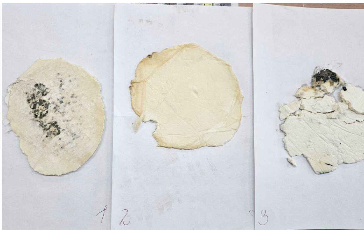
Рис.4 Проверка биоразлагаемости полученного материала. Слева направо: Образец №1, образец №2 и образец №3.
