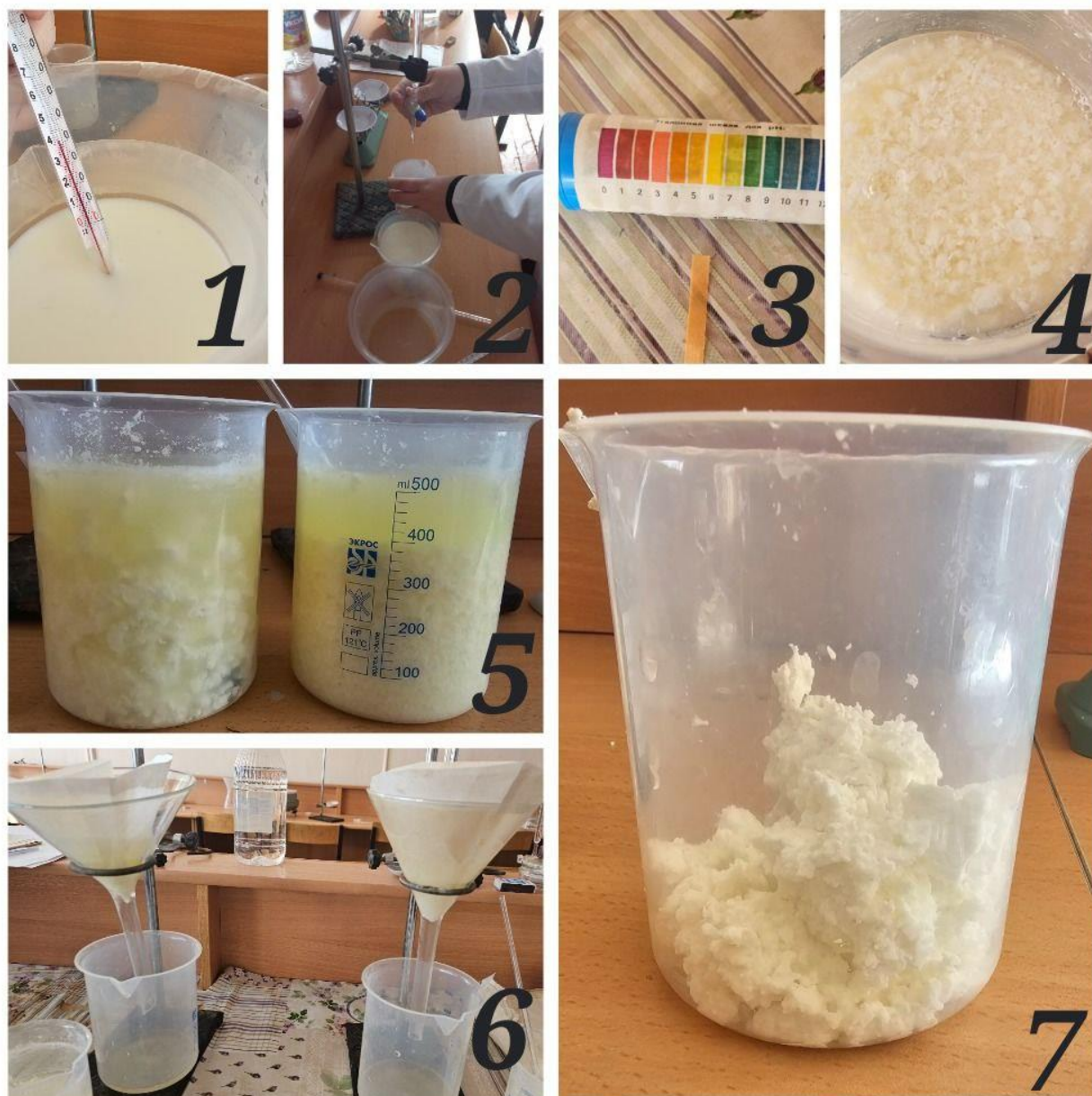
Рис.3 Стадии получения биопластика:
