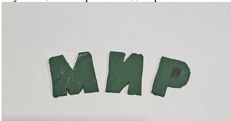
Рис.1 Образцы букв, сделанные из казеинового биопластика
