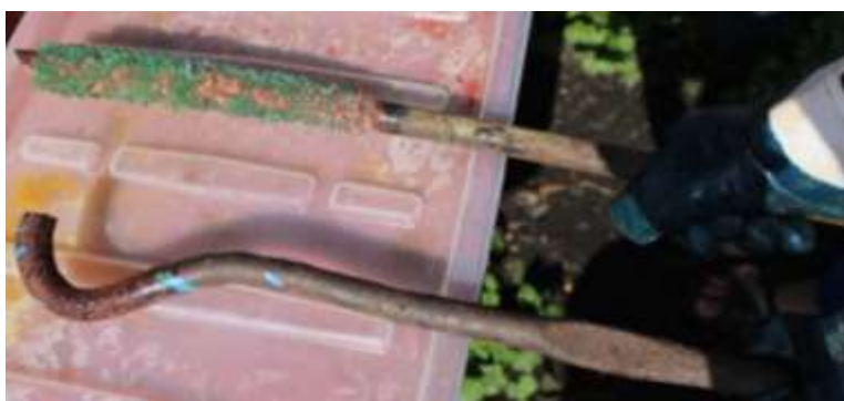
Рисунок 10 – Цементация меди и фильтрация раствора
