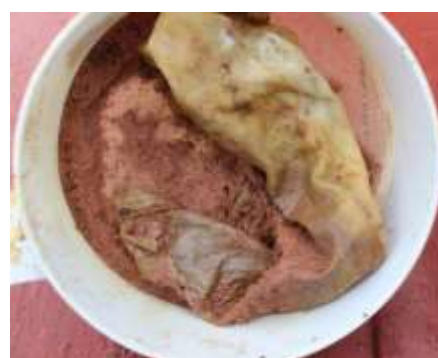
Рисунок 10 – Цементация меди и фильтрация раствора
