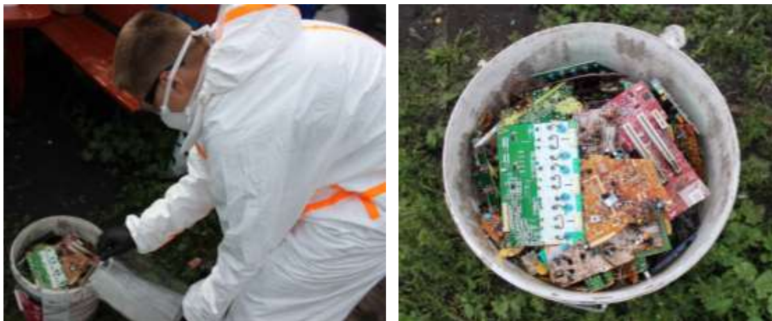
Рисунок 6 – Удаление защитного слоя лака
