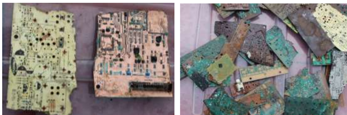
Рисунок 9 – Платы до и после растворения металлов
