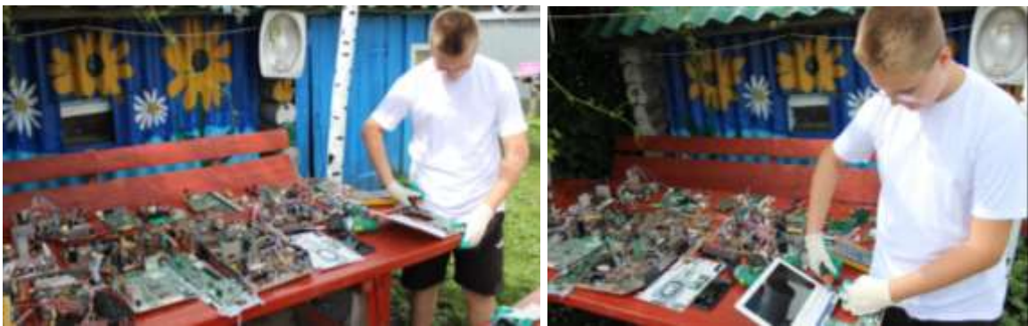
Рисунок 4 – Разборка и подготовка плат
