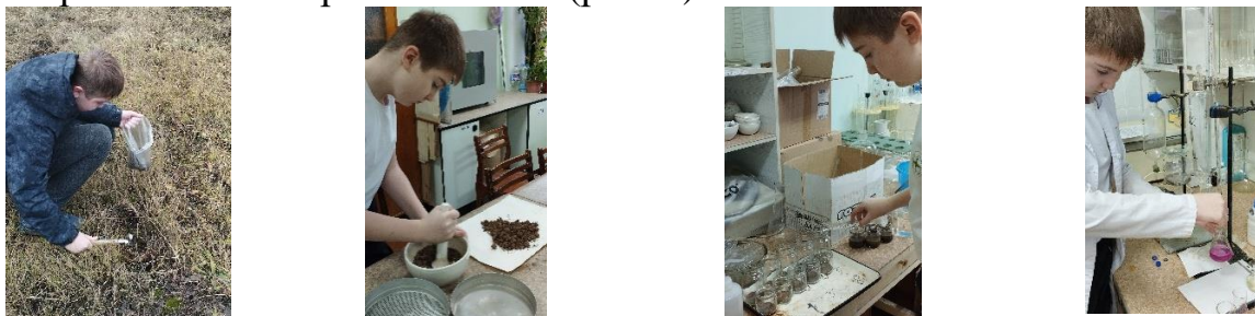
Рис. 4. Отбор, пробоподготовка проб почвы к анализу и определение в них кислотности и суммы поглощенных оснований
