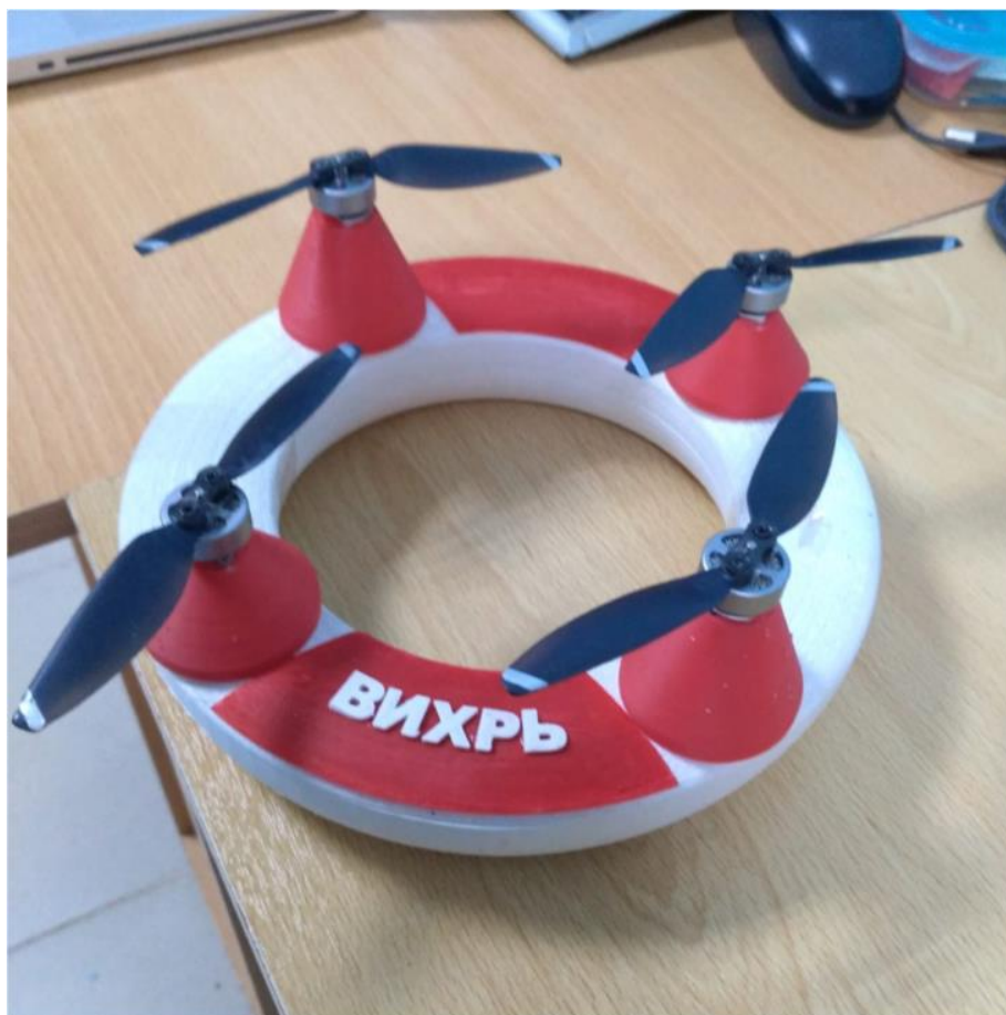
Рисунок 3 – Плавающий квадрокоптер «Вихрь» - действующая модель
