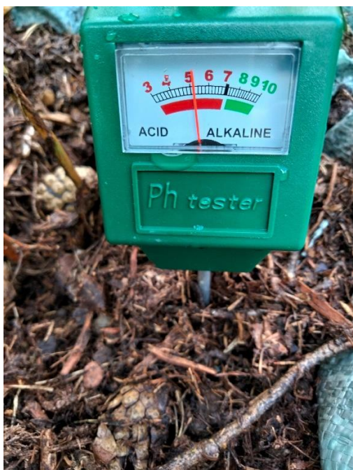
Фото 6 Измерение рН грунта.
