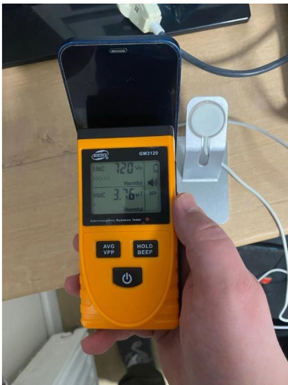
Фото 3. Измерение ЭМИ от iPhone на беспроводной зарядке
