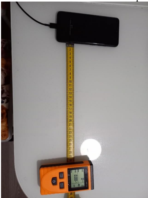
Фото 1. Измерение ЭМИ от телефона Samsung безопасного расстояния
