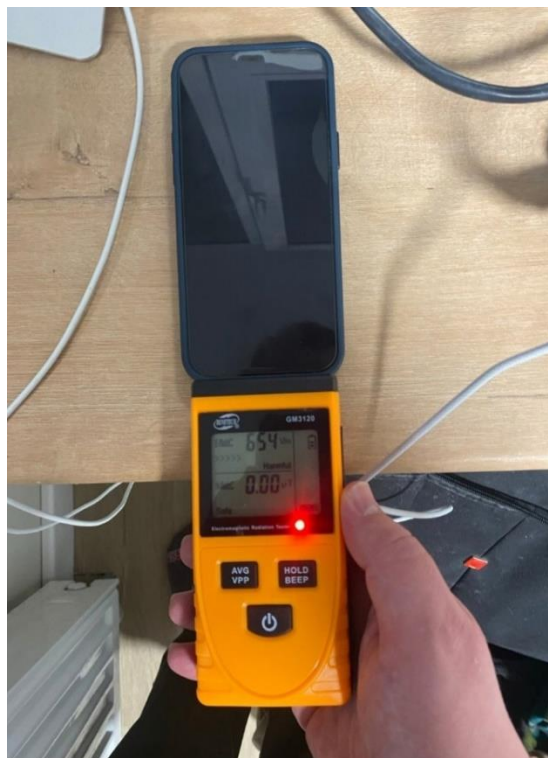
Фото 4. Измерение ЭМИ от iPhone на проводной зарядке
