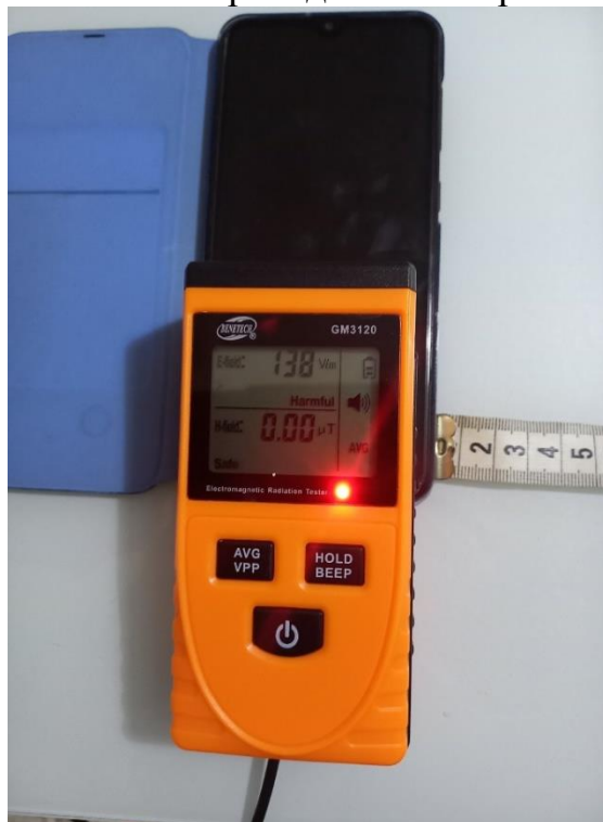
Фото 2. Измерение ЭМИ от телефона Samsung на проводной зарядке
